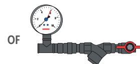
Aansluiting op waterleidingnet. (voorfilter op installatie vereist)
