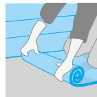
Installatie ter plekke, levering op rollen
