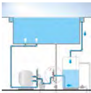
Normale schakeling buffertank/overloopgoot.
